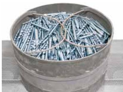
Bläuen von Bohrern mit Wasserdampf in einem Ofen der Baureihe NRA siehe Seite 16
