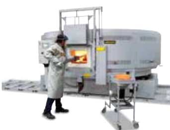
DH 2500/S auf Schienen zum Verfahren zwischen zwei Schmieden
