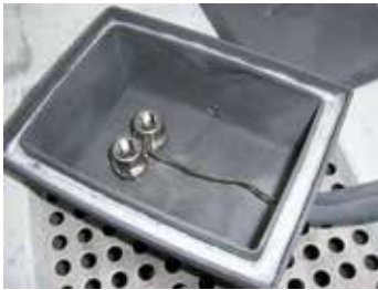
Hartlöten im Begasungskasten
