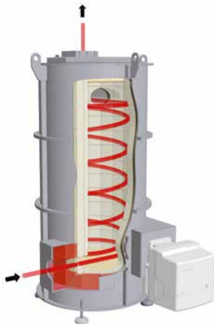
Schematische Darstellung einer thermischen Nachverbrennung (TNV)
