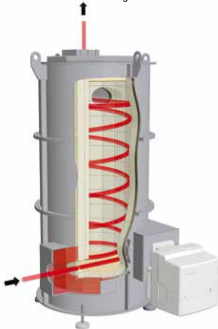
Schematische Darstellung einer thermischen Nachverbrennung (TNV)
