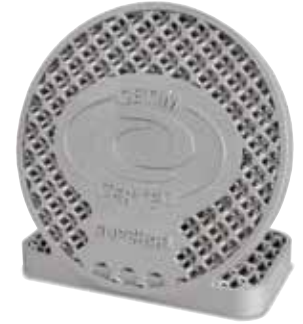
Gedrucktes Bauteil aus Aluminium, wärmebehandelt im Modell N 250/85 HA (Hersteller CETIM CERTEC auf SUPCHAD Plattform)
