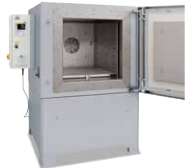
Umluft-Kammerofen NA 250/45 für Wärmebehandlungen an Luft
